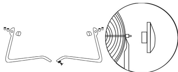
Una los extremos de los tubos y fíjelos con el tornillo de estrella adjunto. Apriete a continuación la tuerca con la llave inglesa suministrada. Coloque el ventilador
