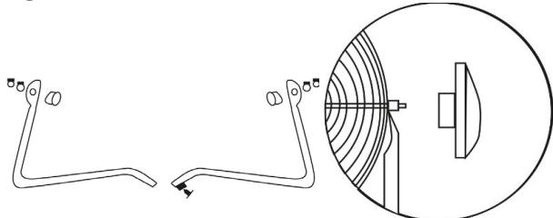
Collegare le due estremità insieme e fissarle con le viti a croce in dotazione. Successivamente fissare i dadi con la chiave in dotazione.
