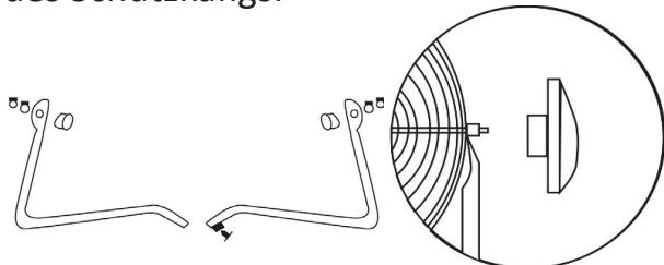
Verbinden Sie dabei die Rohrenden miteinander und sichern Sie diese mit der beiliegenden Kreuzschlitzschraube. Befestigen Sie anschließend die Schraubenmuttern mit dem mitgelieferten Schraubenschlüssel.
