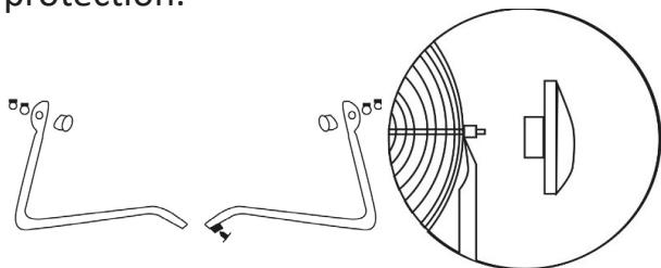
Raccordez, ce faisant, les extrémités des tubes et sécurisez-les avec la vis cruciforme jointe. Fixez ensuite les écrous avec la clé de serrage jointe. Placez le ventilateur dans un emplacement approprié et
