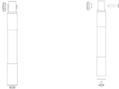
Nehmen Sie die Mittelstange und schrauben Sie diese an dem Standfuß fest.
