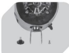
Entnehmen Sie die Schraube aus der Oberseite der Mittelstange und die Schrauben aus der Motoreinheit.
