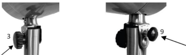
l'unità motore con la gabbia di protezione si inclini.
