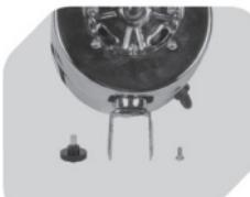
Rimuovere la vite dal lato superiore della barra centrale e le viti dall'unità motore.
