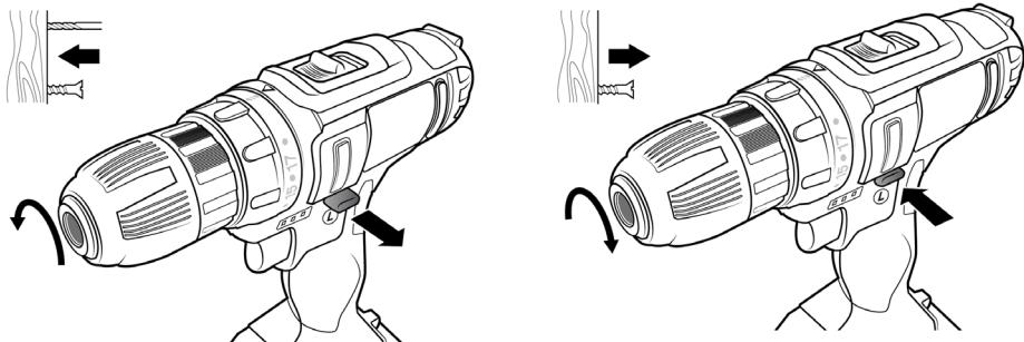
Con il commutatore della direzione di rotazione è possibile commutare la direzione di rotazione corrispondente dell'avvitatore a batteria in base ai propri desideri.
