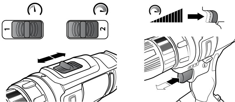
Seleccione la velocidad deseada con el "interruptor de velocidad".
