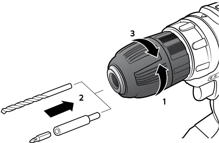
Aprire il mandrino tramite rotazione (1). Inserire l'inserto di avvitatura o foratura (2) desiderato e riavvitare il mandrino (3).
