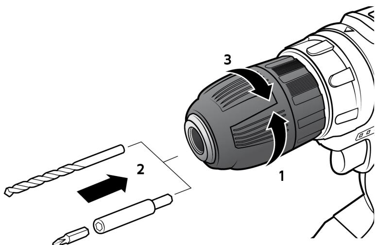
Abra el portabrocas girándolo (1). Coloque el destornillador o la broca deseados (2) y vuelva a cerrar el portabrocas (3).
