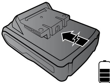
Une prise pour fiche coaxiale se trouve sur la batterie, pour pouvoir recharger la batterie. Chargez la batterie complètement à l'aide du chargeur/la station de recharge livré. Une LED d'état se trouve sur le chargeur/la station de charge. Tant que la LED est allumée en rouge, le processus de recharge est en cours. Lorsque la LED devient verte, la batterie est complètement chargée et peut être utilisée de nouveau.
