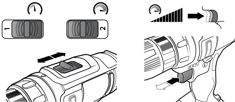
Sélectionnez la vitesse souhaitée au moyen du « commutateur de niveaux de vitesses ».
