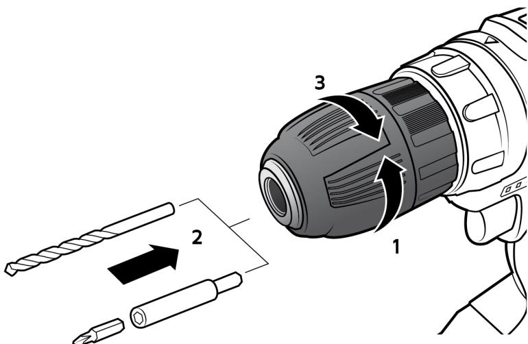
Öffnen Sie das Bohrfutter, indem Sie es aufdrehen (1). Legen Sie den gewünschten Schraub- oder Bohreinsat (2) ein und drehen Sie das Futter wieder fest (3).
