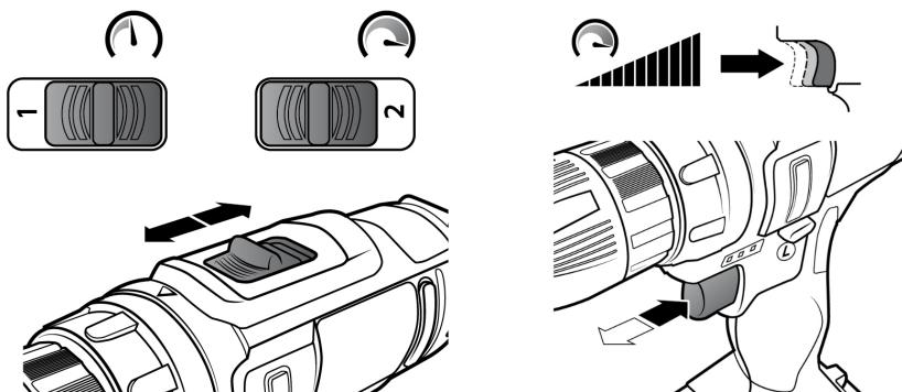
Wählen Sie die gewünschte Geschwindigkeit mit dem „Geschwindigkeitsstufen-Schalter“ aus.
