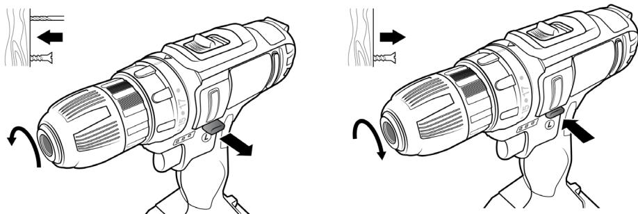
Mit dem Drehrichtungs-Umsteller können Sie die entsprechende Drehrichtung des Akku-Schraubers wie gewünscht umstellen.
