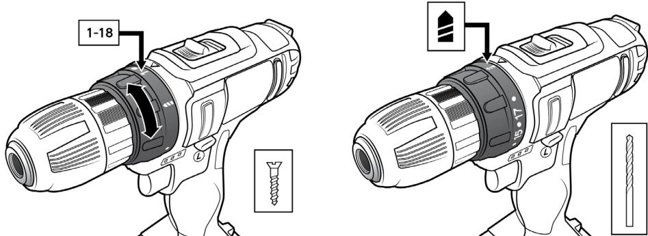
Wählen Sie den gewünschten Drehmoment aus und stellen Sie diesen an dem „Drehmoment-Einstellring“ ein. Hierbei bildet „1“ den geringssten und „18“ den höchsten Widerstand. Wenn Sie bohren möchten, wählen Sie das Bohrer-Symbol aus, hierbei gibt es keine Begrenzung des Drehmoments.
