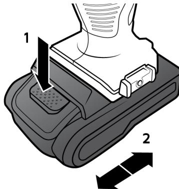
Entriegeln Sie den Akku indem Sie den „Akku- Entriegelung“-Knopf drücken(1) und schieben Sie den Akku im Anschluss vom Gerät ab (2). Um einen neuen Akku einzusetzen, schieben Sie den Akku wieder auf den Akkuschrauber auf (2), bis dieser einrastet.
