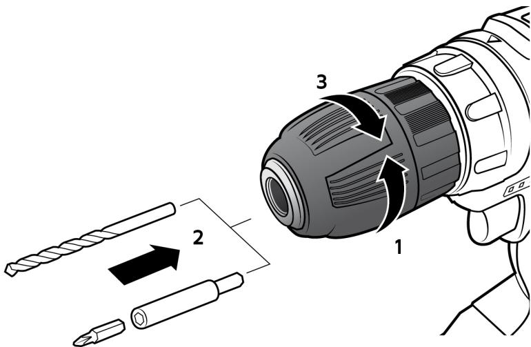
Ouvrez le mandrin en le tournant (1). Placez l'insert de vissage ou de percage souhaité (2) et serrez le mandrin de nouveau en le tournant (3).
