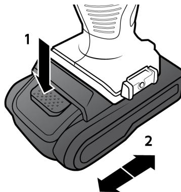
Sbloccare la batteria ricaricabile premendo il tasto "Sbloccaggio batteria ricaricabile" (1) e successivamente spingendo la batteria dall'apparecchio (2). Per inserire una nuova batteria ricaricabile, spingere nuovamente la batteria ricaricabile sul trapano-avvitatore a batteria (2), fino a quando scatta in posizione.
