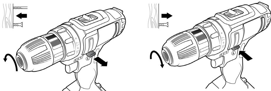
Con el commutador del sentido de giro puede cambiar el sentido de giro del destornillador con batería como desee.
