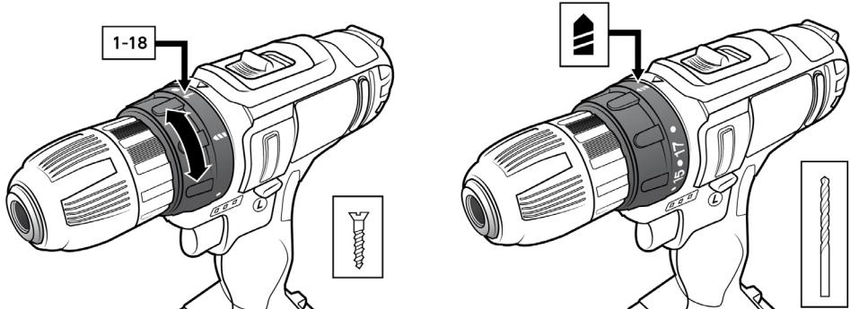
Sélectionnez le couple de rotation souhaité et réglez-le au moyen de la « bague de réglage de couple ». « 1 » représente la résistance la plus faible et « 18 » la plus élevée. Si vous souhaitez percer, sélectionnez le symbole de perçage, il n'y a pas de limitation du couple dans ce cas.
