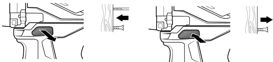
Mit dem Drehrichtungs-Umsteller können Sie die entsprechende Drehrichtung des Akku-Schraubers wie gewünscht umstellen.
