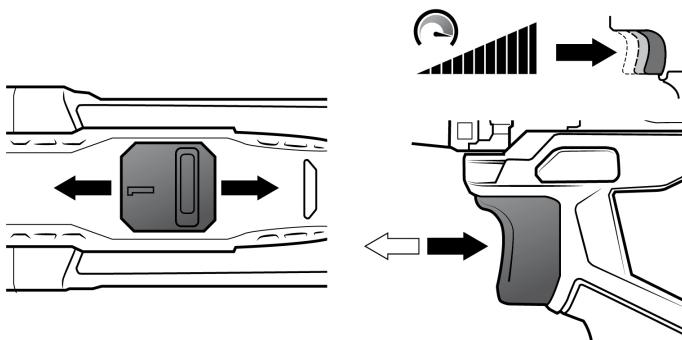
Seleccione la velocidad deseada con el "interruptor de velocidad".
