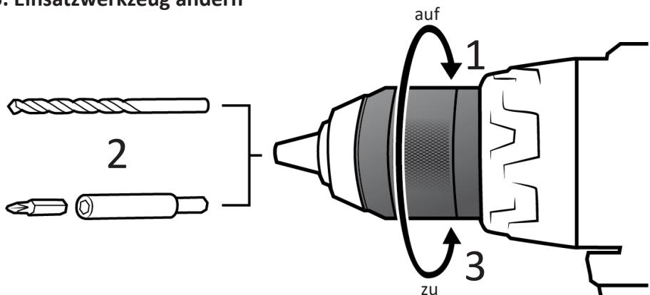
Öffnen Sie das Bohrfutter, indem Sie es aufdrehen (1). Legen Sie den gewünschten Schraub- oder Bohreinsatz (2) ein und drehen Sie das Futter wieder fest (3).
