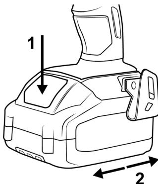
Desbloquee la batería pulsando el "desbloqueo de la batería" (1) y retire la batería la batería del aparato (2). Para colocar una batería nueva, insértela en el destornillador con batería (2) hasta que se encaje.
