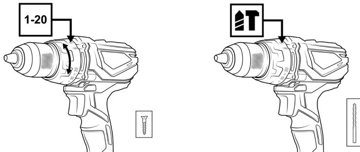
Wählen Sie den gewünschten Drehmoment aus und stellen Sie diesen an dem „Drehmoment-Einstellring“ ein. Hierbei bildet „1“ den geringsten und „20“ den höchsten Widerstand. Wenn Sie bohren möchten, wählen Sie das Bohrer-Symbol aus, hierbei gibt es keine Begrenzung des Drehmoments. Das Hammer-Symbol aktiviert die Schlag-Funktion.
