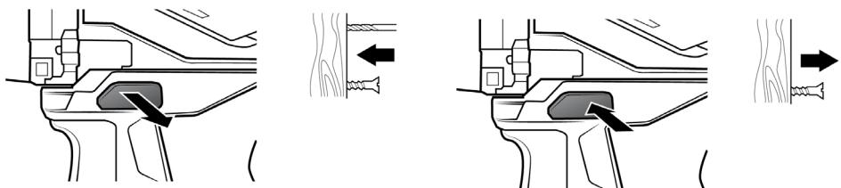
Con il commutatore della direzione di rotazione è possibile commutare la direzione di rotazione corrispondente dell'avvitatore a batteria in base ai propri desideri.
