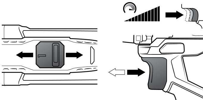
Wählen Sie die gewünschte Geschwindigkeit mit dem „Geschwindigkeitsstufen-Schalter“ aus.
