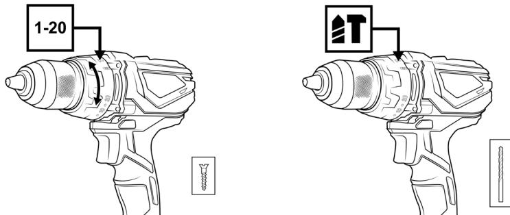
Sélectionnez le couple de rotation souhaité et réglez-le au moyen de la « bague de réglage de couple ». « 1 » représente la résistance la plus faible et « 20 » la plus élevée. Si vous souhaitez percer, sélectionnez le symbole de perçage, il n'y a pas de limitation du couple dans ce cas. Le symbole de marteau active la fonction de percussion.
