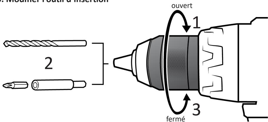
Ouvrez le mandrin en le tournant (1). Placez l'insert de vissage ou de perçage souhaité (2) et serrez le mandrin de nouveau fermement (3).
