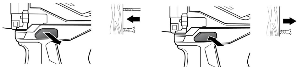
Con el commutador del sentido de giro puede cambiar el sentido de giro del destornillador con batería como desee.
