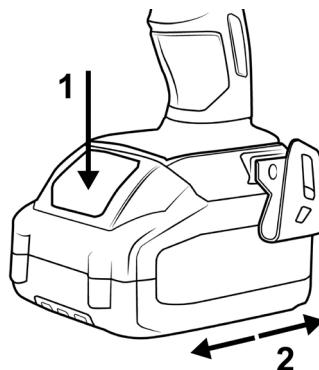
Sbloccare la batteria ricaricabile premendo il tasto "Sbloccaggio batteria ricaricabile" (1) e successivamente spingendo la batteria dall'apparecchio (2). Per inserire una nuova batteria ricaricabile, spingere nuovamente la batteria ricaricabile sul trapano-avvitatore a batteria (2), fino a quando scatta in posizione.
