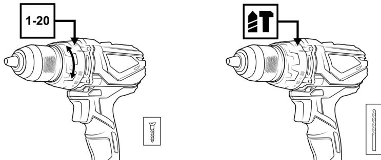
Seleccione el par de giro deseado y ajústelo con el "anillo giratorio para el par de giro". "1" indica la resistencia más baja y "20", la más alta. Si desea utilizar el aparato como un taladro, seleccione el símbolo de taladro; en ese caso el par de giro no tendrá ninguna limitación. El símbolo de martillo activa la función de percusión.
