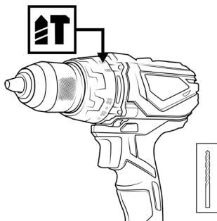
Seleccione el par de giro deseado y ajústelo con el "anillo giratorio para el par de giro". "1" indica la resistencia más baja y "20", la más alta. Si desea utilizar el aparato como un taladro, seleccione el símbolo de taladro; en ese caso el par de giro no tendrá ninguna limitación. El símbolo de martillo activa la función de percusión.
