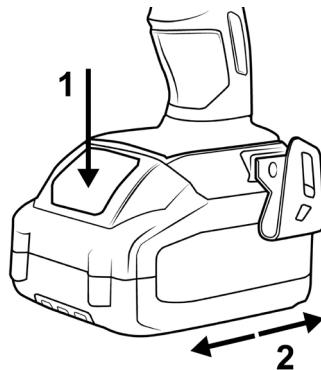
Déverrouillez la batterie en appuyant sur le bouton de « Déverrouillage de batterie » (1) et poussez ensuite la batterie hors de l'appareil (2). Pour insérer une nouvelle batterie, glissez la batterie de nouveau sur la visseuse à batterie (2) jusqu'à ce qu'elle s'enclenche.
