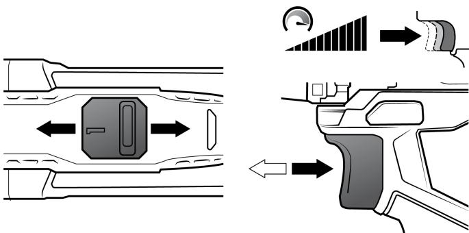
Sélectionnez la vitesse souhaitée au moyen du « commutateur de niveaux de vitesses ».
