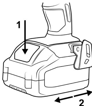
Entriegeln Sie den Akku indem Sie den „Akku- Entriegelung“-Knopf drücken (1) und schieben Sie den Akku im Anschluss vom Gerät ab (2). Um einen neuen Akku einzusetzen, schieben Sie den Akku wieder auf den Akkuschrauber auf (2), bis dieser einrastet.
