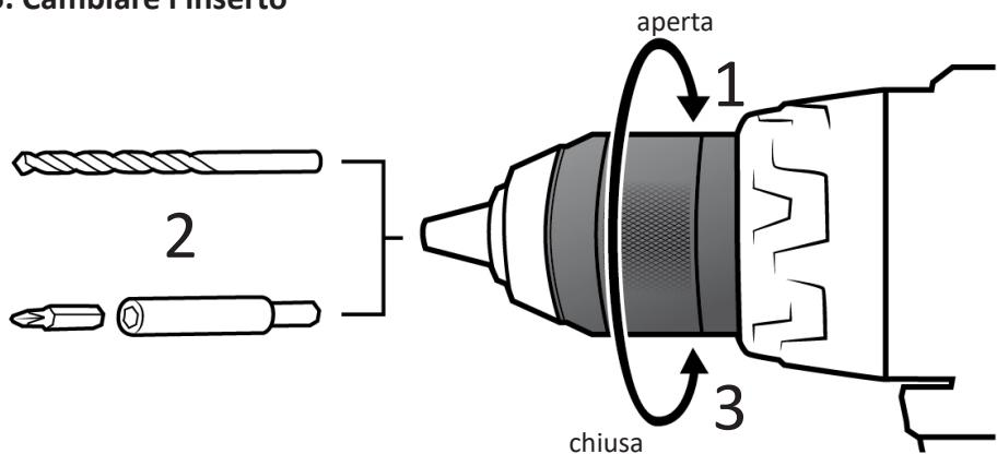
Aprire il mandrino tramite rotazione (1). Inserire l'inserto di avvitatura o foratura (2) desiderato e riavvitare il mandrino (3).
