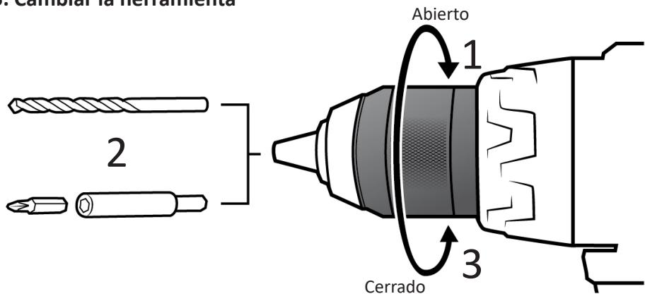
Abra el portabrocas girándolo (1). Coloque el destornillador o la broca deseados (2) y vuelva a cerrar el portabrocas (3).
