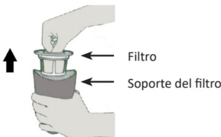
**Indicación:** En caso necesario, puede limpiar el filtro con agua templada. Seque luego el filtro por completo antes de volver a utilizar la unidad del filtro.
