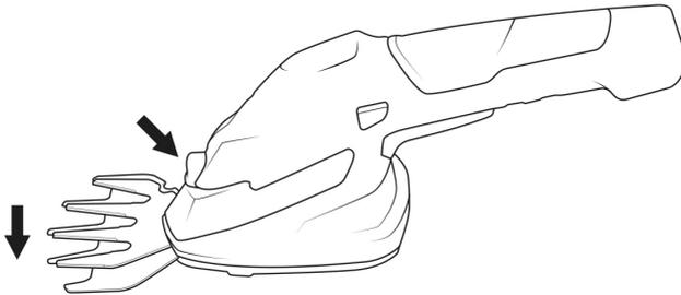
Nach dem Herausnehmen der Klinge können Sie die Zahnräder des Getriebes sehen. Achten Sie darauf, dass beim Wechseln der Klinge kein Schmutz in das Getriebe gelangt.
