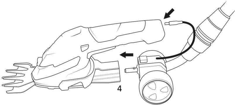
Per regolare il manico telescopico alla lunghezza desiderata, allentare il giunto di serraggio dell'asta telescopica (7) e posizionare l'asta alla lunghezza desiderata. Infine, stringere di nuovo il giunto di serraggio.
