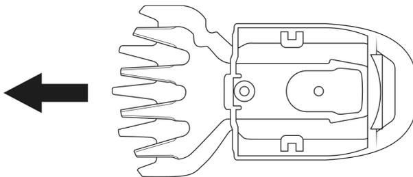
Montieren Sie die Heckenscherenmesser. Wenn Sie ein deutliches Klacken hören, bedeutet dies, dass die Klinge korrekt montiert ist.
