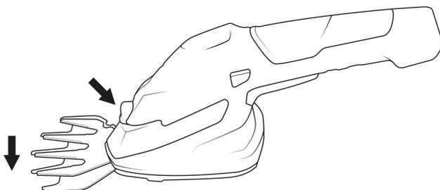
Después de sacar las hojas pueden verse los engranajes del motor. Preste atención a que no entre ninguna suciedad en el mecanismo al cambiar las hojas de corte.
