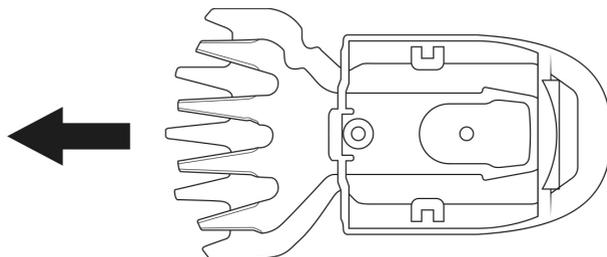
Monte las cuchillas del cortasetos. Si se oye un sonido claro de chasquido, significa que la cuchilla está correctamente montada.
