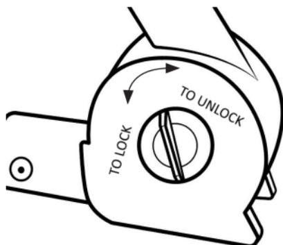
Durch die Schrauben an der linken und rechten Seite des Gerätes können Sie den Baustrahler feststellen.
