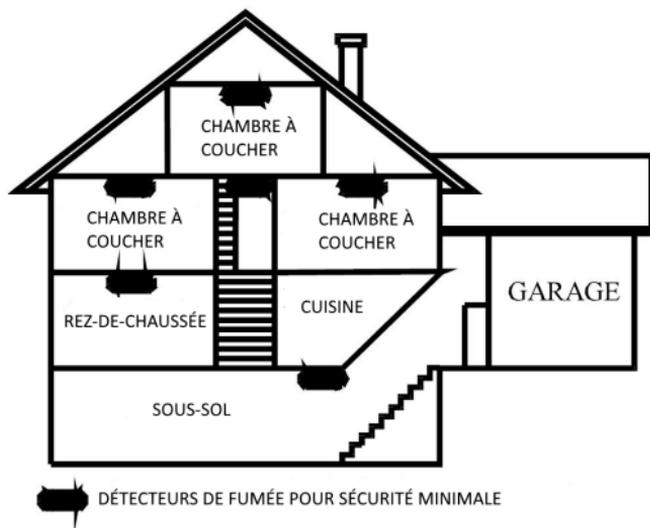
10. Vérifiez qu'aucune porte ni d'autre obstruction ne bloque le passage de la fumée jusqu'à détecteur.
