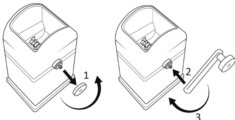
Schrauben Sie den Gewindeschutz von der Rückseite des Gerätes ab.
