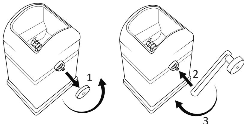
Desatornille la protección de la rosca de la parte posterior del aparato.
