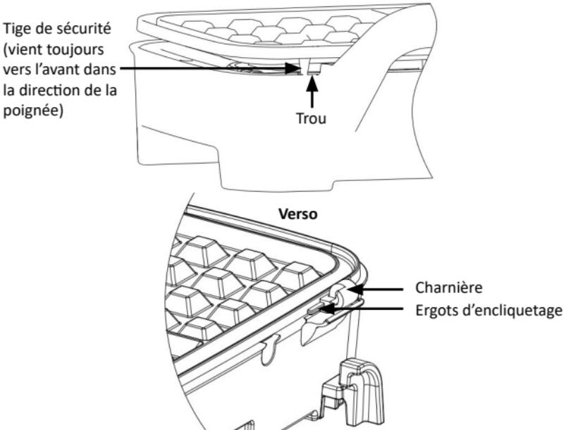
1. Placez les deux plaques avec les ergots d'encliquetage du côté de la charnière et enfoncez les plaques vers le bas dans le support jusqu'à ce qu'elles s'enclenchent audiblement.
