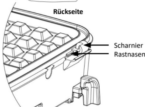
1. Setzen Sie die beiden Platten mit den Rastnasen zu dem Scharnier zeigend ein und drücken Sie die Platten in die Halterung nach unten, bis diese mit einem hörbaren Geräusch einrasten.
