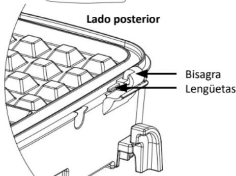
1. Inserte las dos placas con las lengüetas mirando hacia la bisagra y presione las placas hacia abajo sobre el soporte hasta que oiga que han encajado en su lugar.
