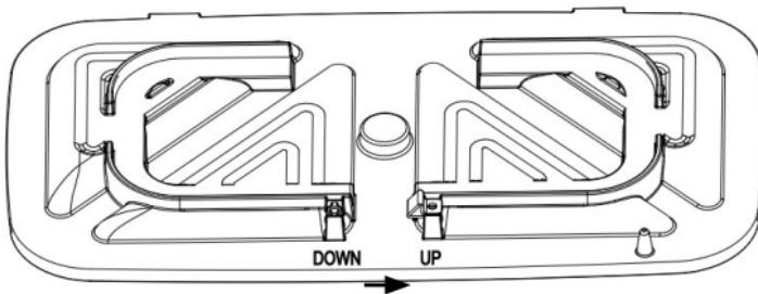
2. Il blocco in posizione "DOWN" è per la piastra inferiore.
