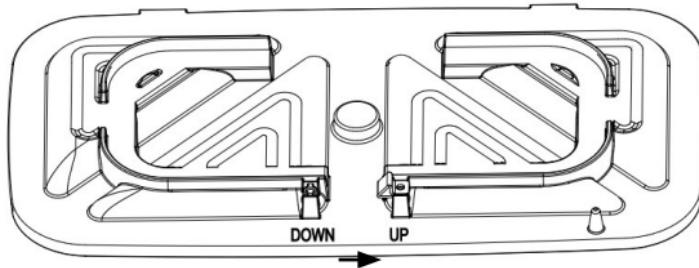
2. El bloqueo en la posición «DOWN» sirve para la placa inferior.
