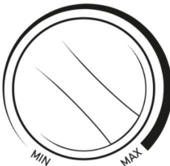
Con il "Regolatore di temperatura" selezionare la temperatura. "MIN" è la temperatura più bassa e "MAX" corrisponde a quella più alta. Per spegnere l'apparecchio, girare il "Regolatore di temperatura" in senso antiorario fino a quando l'apparecchio non si spegne con un "click" udibile.
