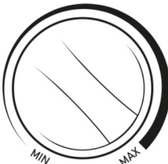
Mit dem "Temperaturregler" wählen Sie die gewünschte Temperatur aus. "MIN" ist die niedrigste Temperatur und "MAX" entspricht der höchsten. Um das Gerät auszuschalten, drehen Sie den "Temperaturregler" gegen den Uhrzeigersinn, bis das Gerät mit einem hörbaren "Klick" sich ausschaltet.
