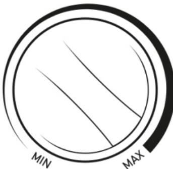
Con el "Regulador de temperatura" podrá seleccionar la temperatura deseada. "MIN" es la temperatura más baja, y "MAX" se corresponde con la más alta. Para apagar el aparato, gire el "Regulador de temperatura" en sentido contrario a las agujas del reloj hasta que se apague al oír un "clic".
